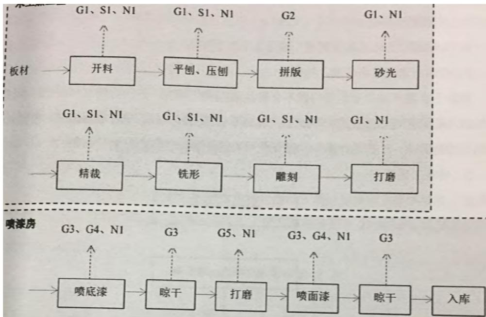
图 2-1 建设项目工艺流程图及产污环节
